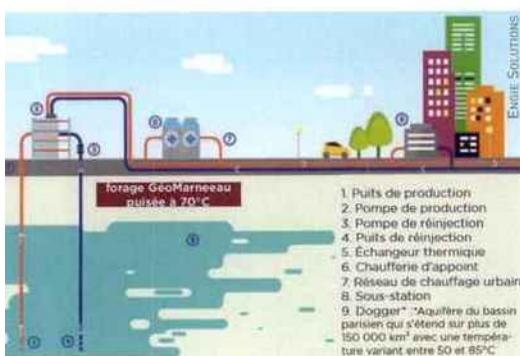
Schéma du réseau de géothermie de GéoMarne
